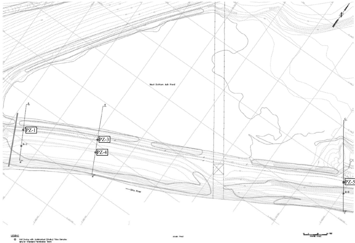
FIGURE 1. WEST BOILER SLAG POND PIEZOMETERS LOCATION PLAN
