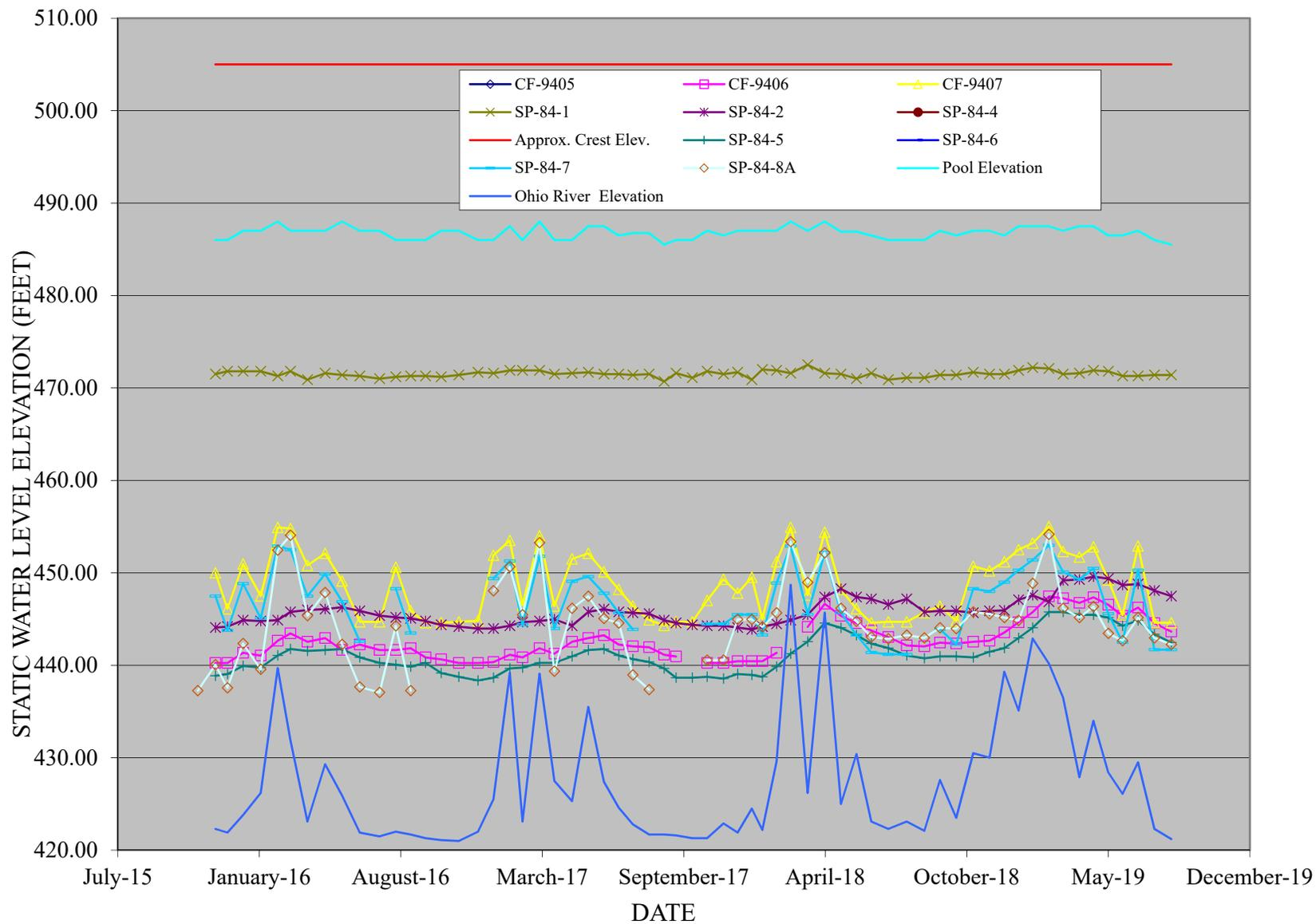
FIGURE 4. LANDFILL RUNOFF COLLECTION POND PIEZOMETERS MEASUREMENTS
