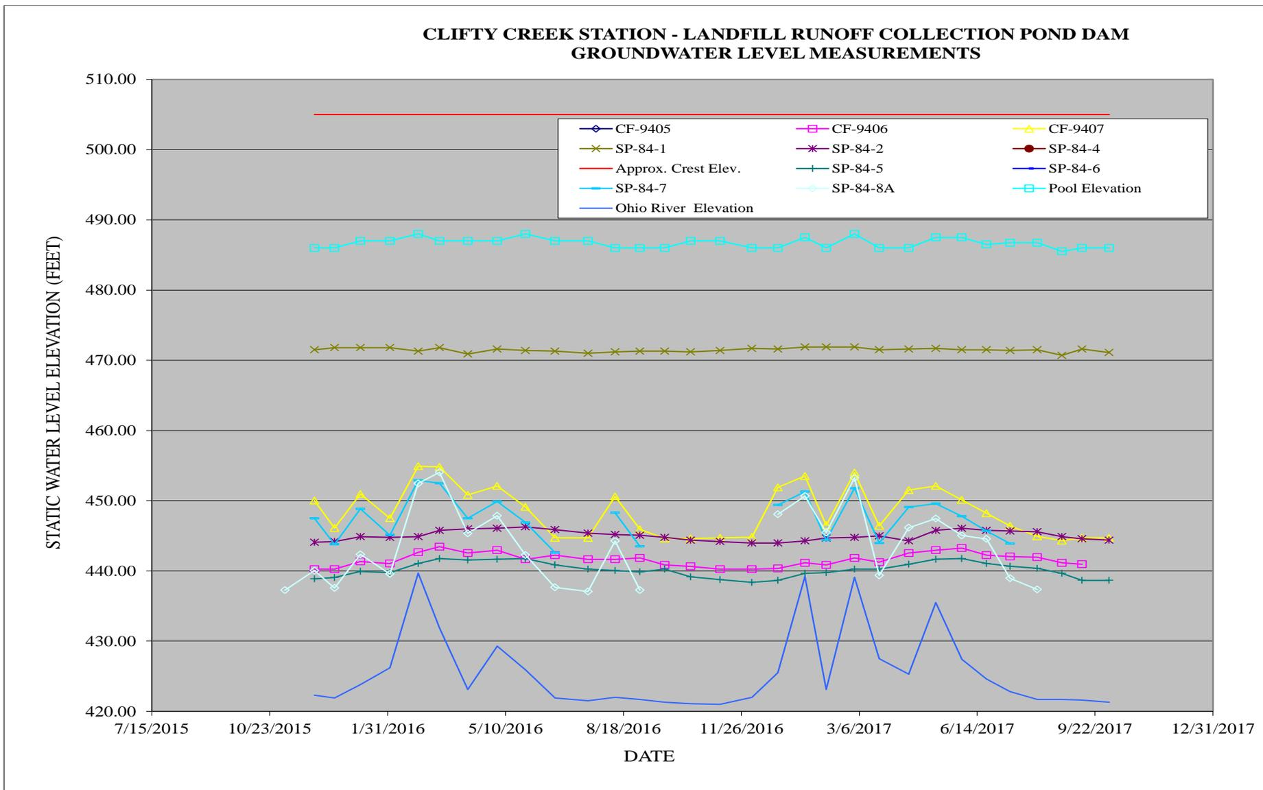
FIGURE 4. LANDFILL RUNOFF COLLECTION POND GROUNDWATER LEVEL MEASUREMENTS
